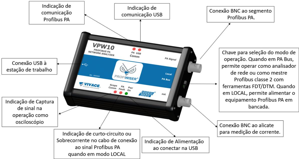
Figura 3.1 – Etiqueta de identificação do VPW10.
