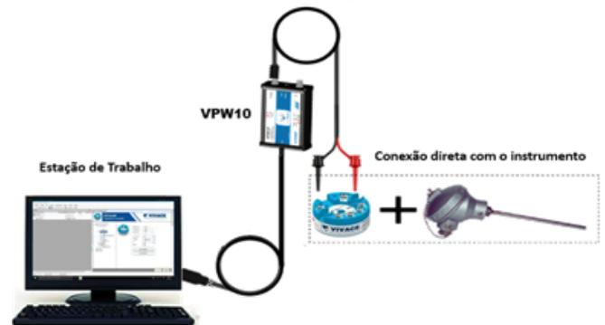
Figura 8.2 – Conexão para o modo de operação "Local".
